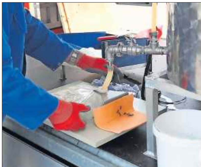
Der pasteurisierte Saft wird in in Folienbeutel abgefüllt, die Beutel werden in Kartons gesteckt.
